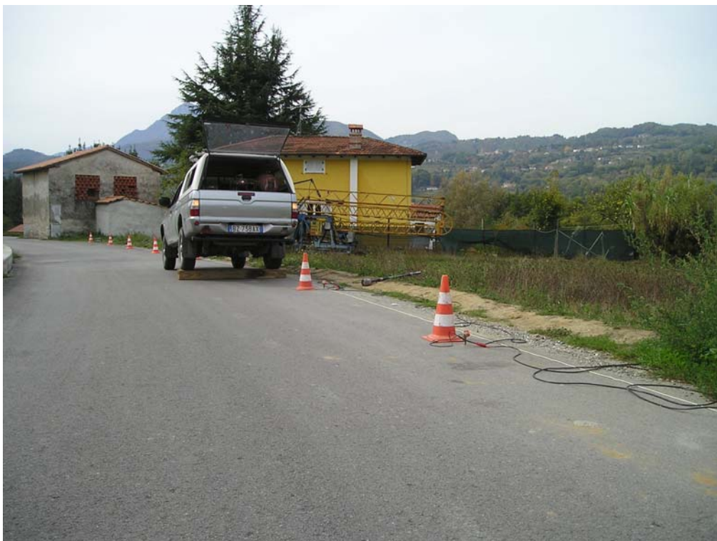
Profilo ST4: energizzazione onde SH su D2 = G18/19
