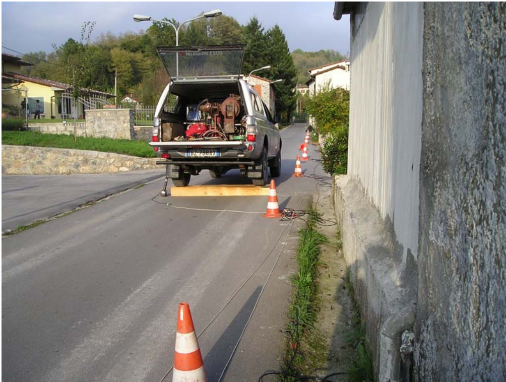
Profilo ST5: energizzazione onde SH su D1 = G 6/7
